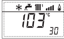
31. Visualización del valor de temperatura de la sonda solar con tarjeta solar
