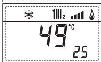
26. Visualização termostato de segurança com placa ZONA MIX 2 (entrada S1) respetivamente ON e OFF
