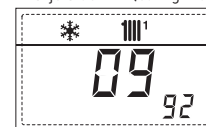
92. Versión de software instalada en 2.ª tarjeta de EXP (config. ZONA MIX)
